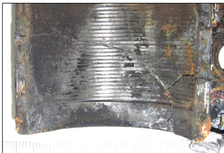
Рис. 6. Следы в виде борозд на магнитах статора.
