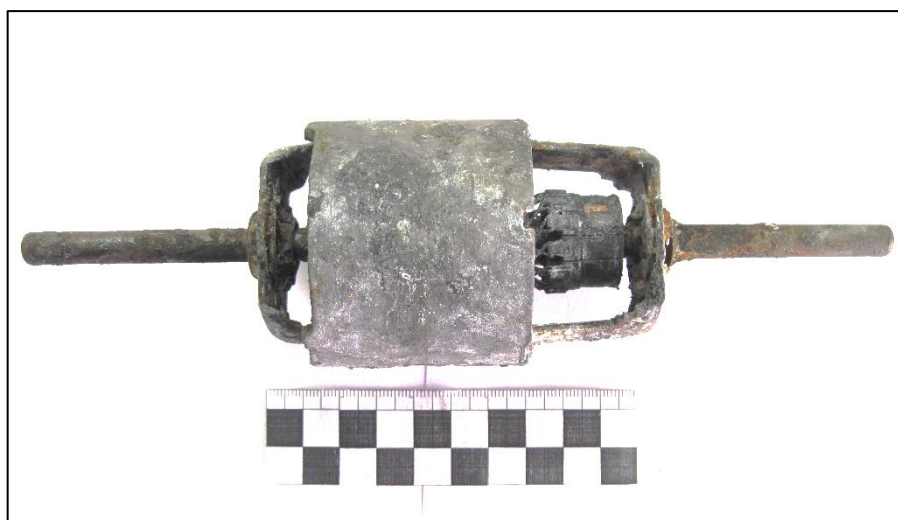
Рис. 3. Вид сохранившихся металлических деталей электродвигателя отопителя.
