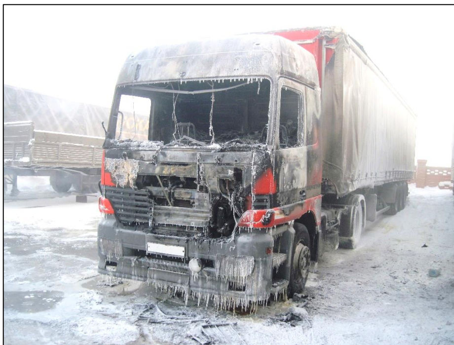
Рис. 1. Передняя часть автомобиля со следами термического воздействия.
