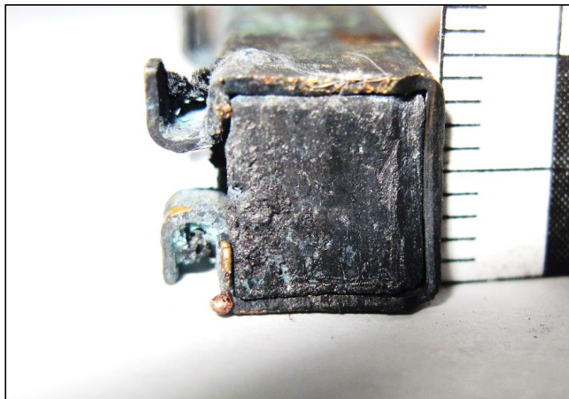
Рис. 8 – Следы повреждения одной из щеток.
