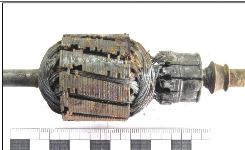
Рис. 5. Следы деформации (сдвига) пластин ротора.
