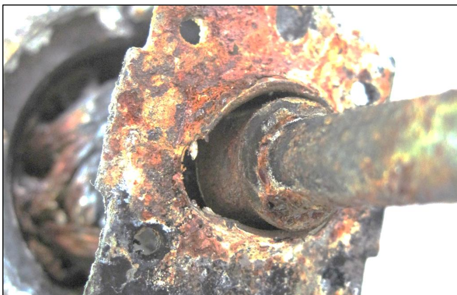
Рис. 4. Следы значительного износа посадочного места втулки и её самой.
