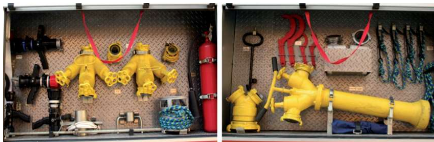
Рис.5. Пожарно-техническое оборудование, покрытое специальным криогенным составом
