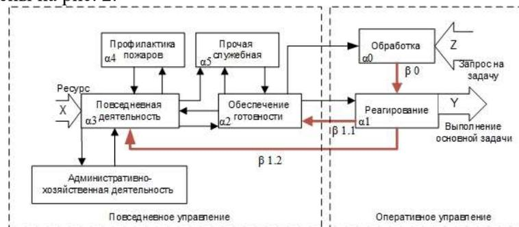
Рис. 2. Основные функциональные элементы системы управления типовым пожарно-спасательным подразделением
