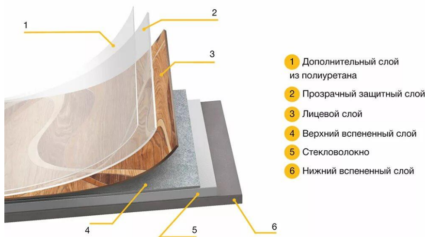
Рис.1. Структура линолеума натурального
