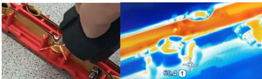
Рис. 4. Искры, электрическая дуга, нагрев контактных пластин при больших переходных сопротивлениях
