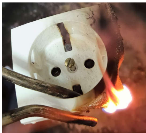
Рис. 6. Результаты воздействия открытого пламени на декоративные элементы розетки
