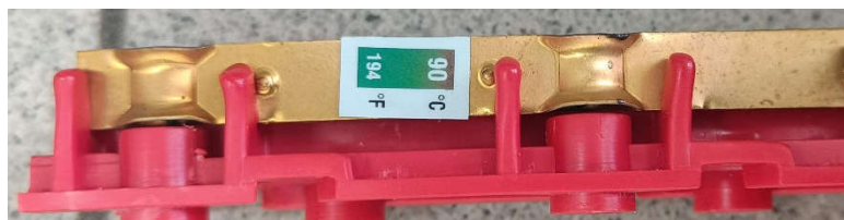
Рис. 8. Размещение термоиндикатора на контактной пластине
