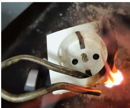
*Рис. 7. Горение после прекращения воздействия пламени на элементы электрической розетки*
