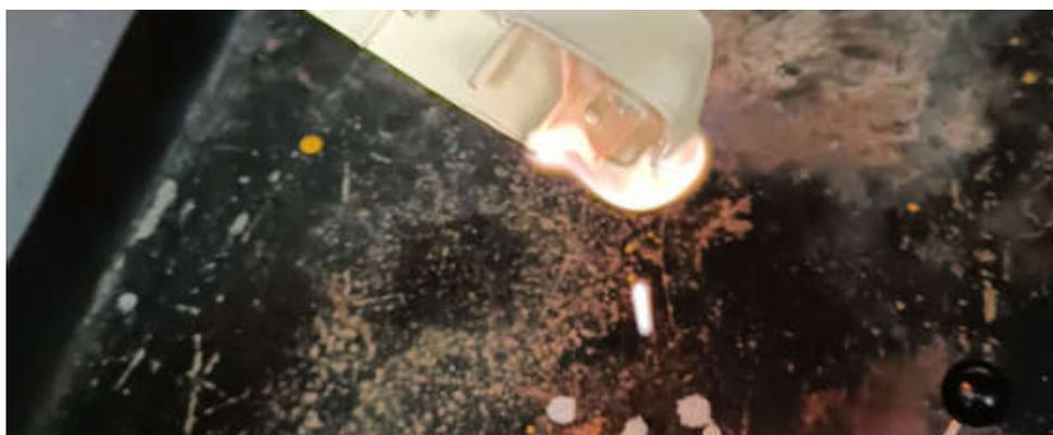
*Рис. 8. Каплепадение с продолжающимся горением корпуса удлинителя*
