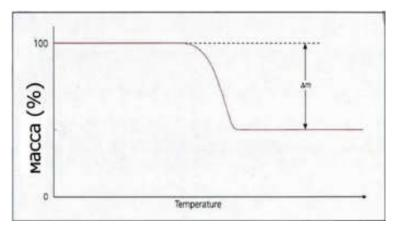
Рис. 2. Схематическая кривая термогравиметрии полимера
