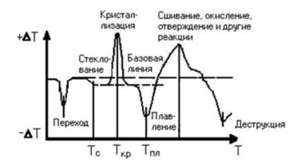
Рис. 3. Схематическая кривая дифференциально-термического анализа полимера
