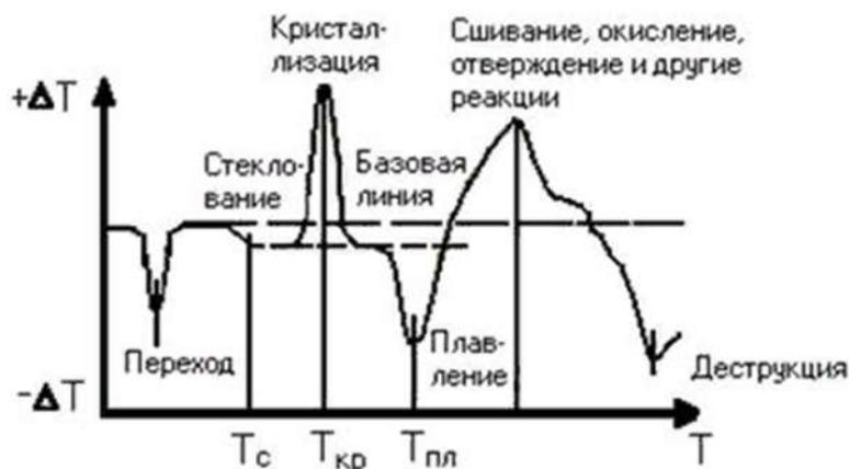
Рис. 3. Схематическая кривая дифференциально-термического анализа полимера
