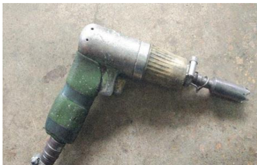
Рис. 7. Вид ручного механизированного инструмента для вскрытия строительных конструкций с саморезами, разработанного (приспособленного) на основе пневматического пистолета [6]
