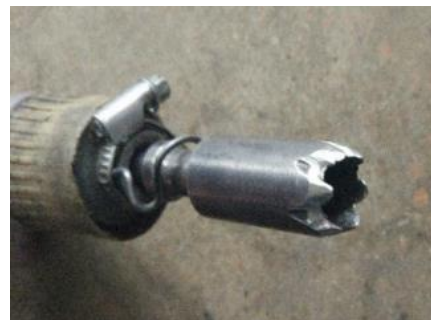
Рис. 7. Вид ручного механизированного инструмента для вскрытия строительных конструкций с саморезами, разработанного (приспособленного) на основе пневматического пистолета [6]
