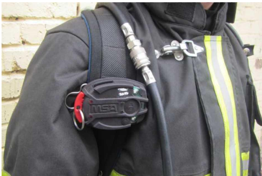
Рисунок 2. Датчик неподвижного состояния
