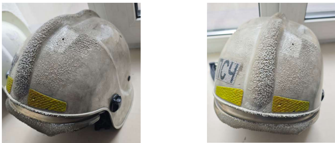
Рис. 2. Оплавление шлемов пожарного при воздействии высоких температур
