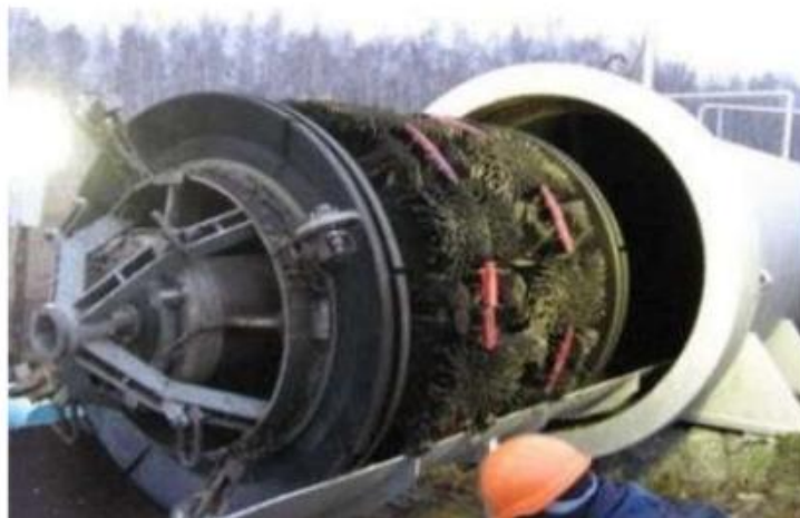
Рис. 3. Внутритрубный диагностический снаряд-дефектоскоп
