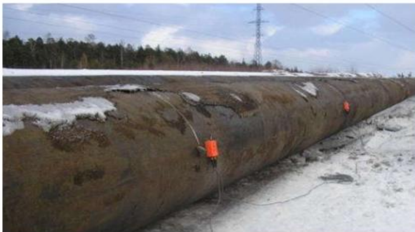
Рис. 4. Метод акустической эмиссии
