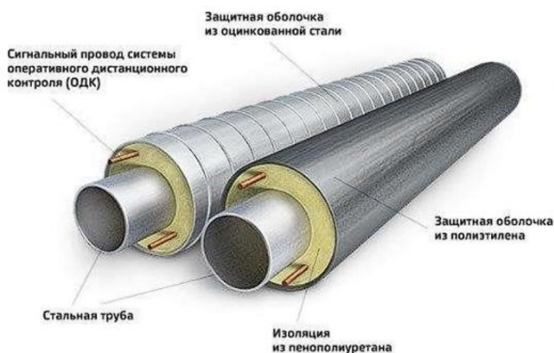
Рис. 10. Состав трубопровода с заложенными датчиками
