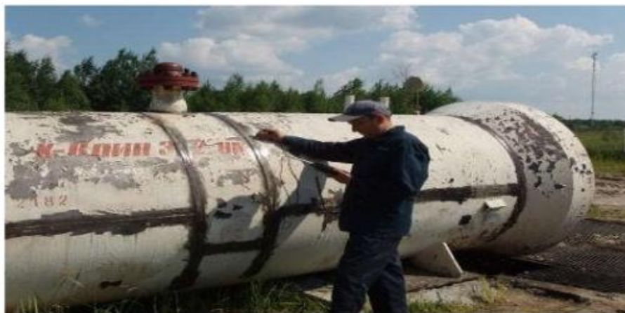
Рис. 5. Сканирование трубы методом магнитной памяти металла
