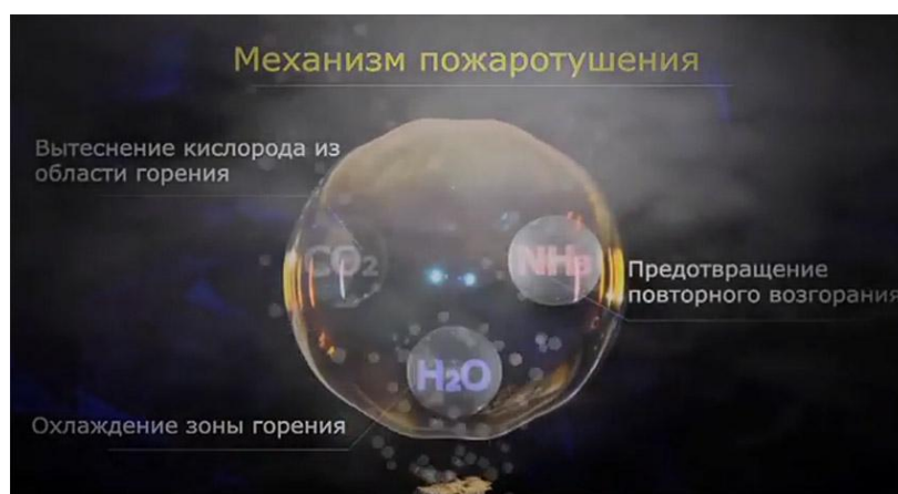
Рис. 1. Механизм пожаротушения огнетушащих капсул.
