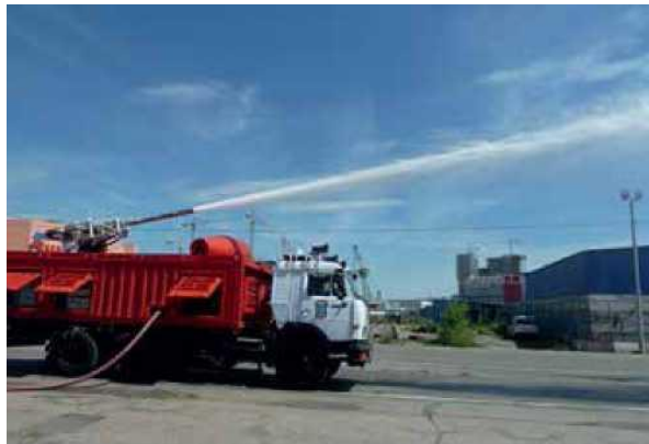
Рис.1. Система дистанционной подачи мелкодисперсной водяной струи «СГТ»
