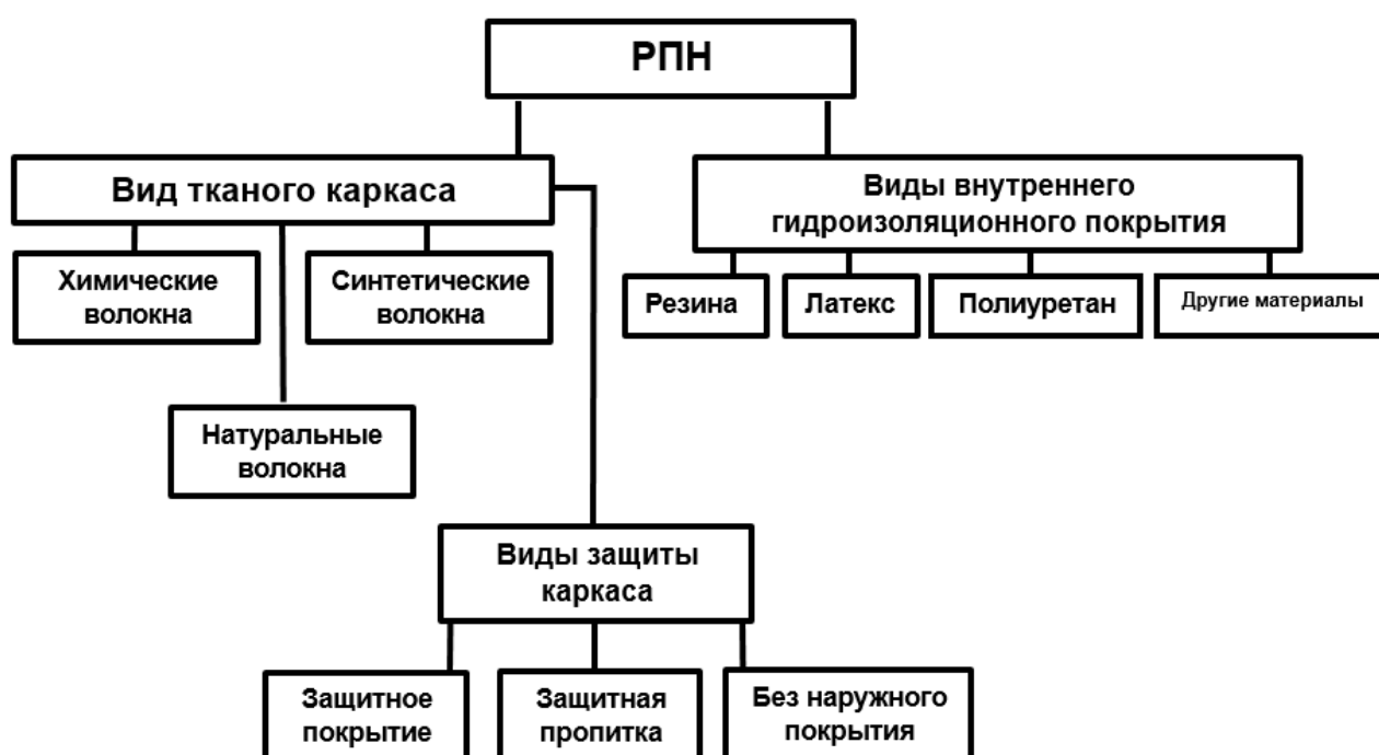
Рисунок 1. Классификация напорных пожарных рукавов в зависимости от вида тканого каркаса и внутреннего гидроизоляционного покрытия
